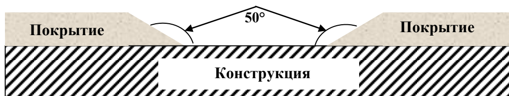
Рисунок 1 - Схема обработки краев зоны очистки дефектного покрытия
